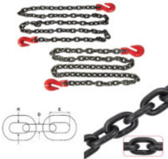
Las cadenas grado 80 están fabricadas con acero aleado tratado y templado. Son aptas para el izaje y se utilizan ampliamente en el manejo y amarre de la carga, y puede soportar hasta 200°C sin reducir su capacidad de carga. Las cadenas de grado 80 están marcadas en el lado no soldado de los eslabones.
